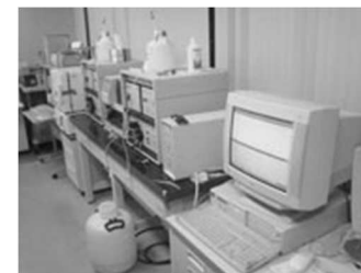
イオンクロマトグラフィー
