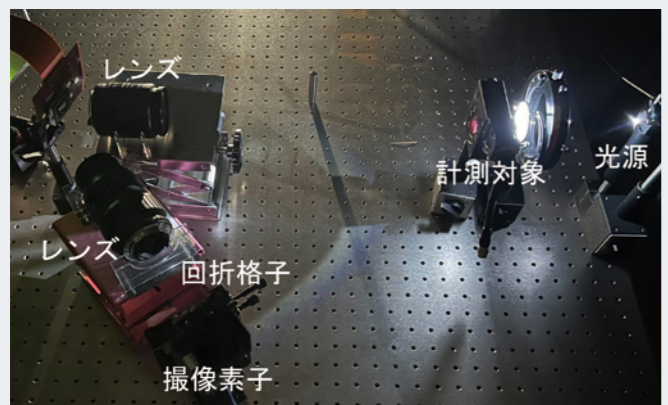
写真1 回折格子を利用した分光イメージングの光学システム
