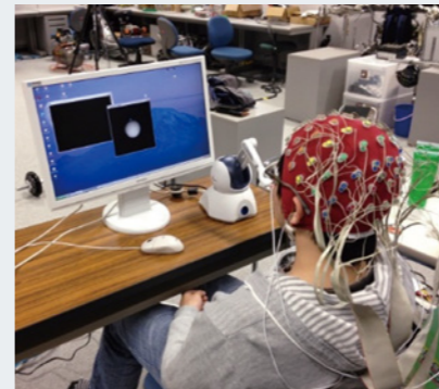
写真1 力を調整する技能に関する実験。脳波計を装着した被験者が力覚デバイスを操作する
