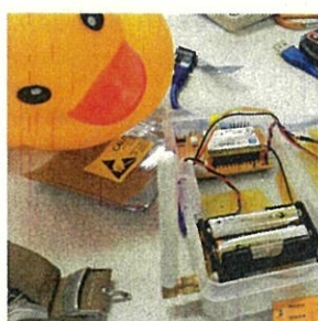
(端末設置 AC アダプターは不要、乾電池 2 本で数か月稼働)
