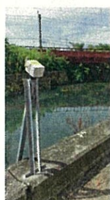
御坊市の用水路に設置されている水位計
