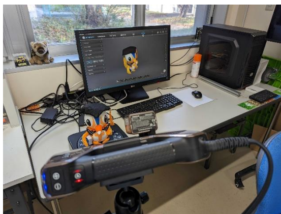
図 2. 3D スキャナ (EinScan Pro HD) によるスキャン作業の様子
