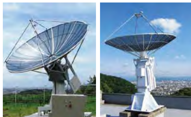
図2 上：12m（X波受信／S波送受信）， 左下：移動式3m（S波送受信）， 右下：3m（X波受信／S波送受信）
