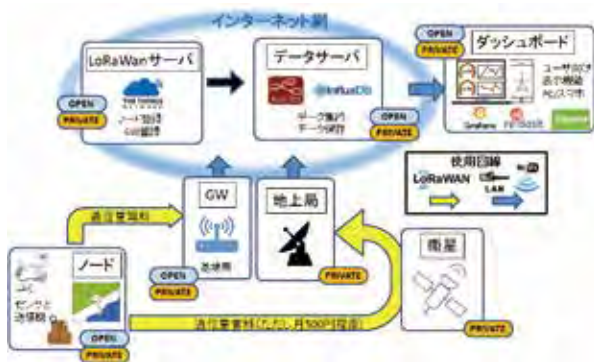
図4 LoRaWANを使ったIoTシステム図
