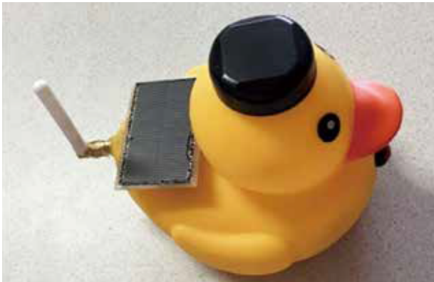
図11 GPS付き防水温度計
