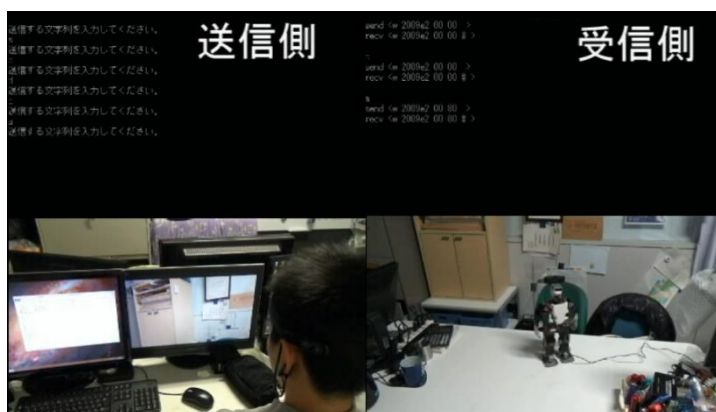
図9 脳波によるロボット遠隔操作の様子
